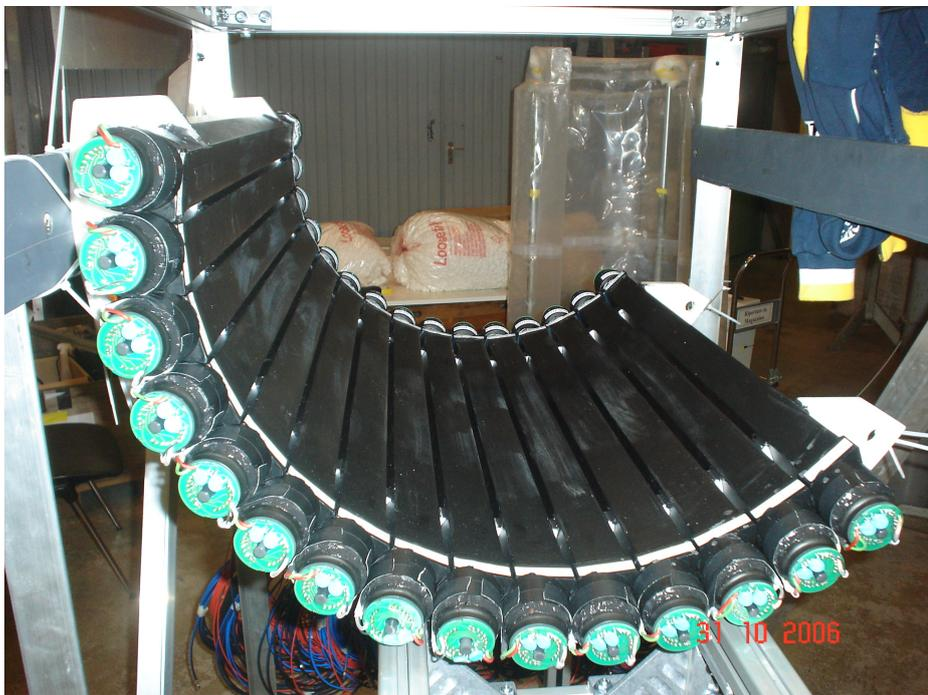
Figura 3.1: Il rivelatore longitudinale.
