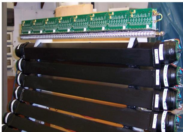
**Figura 5.7:** Posizionamento della barra di supporto sulla struttura del rivelatore longitudinale.
