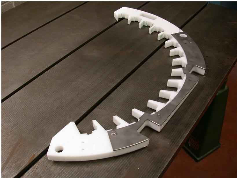
**Figura 3.3:** Supporto in plexiglass del rivelatore longitudinale e rinforzo in acciaio.
