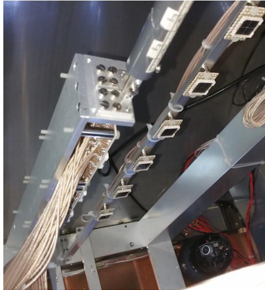
図 7.5 セットアップ内部の写真。MPPC の取り付けられたロッド、トリガーチャンネル、アルファ線ワイヤ、内部状態を見渡すためのカメラが確認できる。
