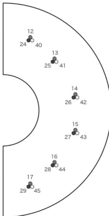
図 8.9 検出器の上流側壁面に設置された LED の配置。マーカーの色の違いは光量の強さに対応し、数字は各 LED のラベリング用の番号である。
