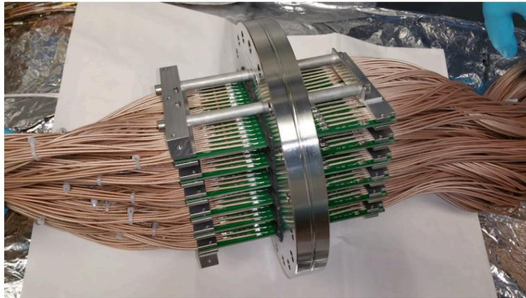
図 6.22 ガンマ線検出器に用いる信号読み出し・電圧印加用のフィードスルー。
