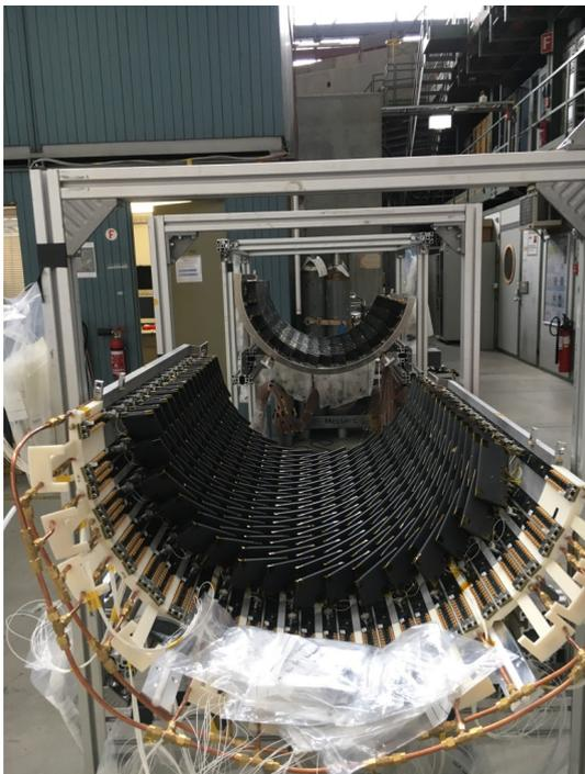
図 5.4 ビームラインにインストールする前の上流側・下流側併せたタイミングカウンター。
