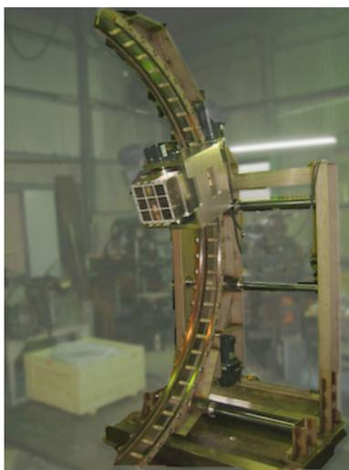
図 4.13 ガンマ線検出器の較正に用いる BGO 検出器。検出器全体をスキャンできるように検出器部分はレールに沿って移動可能となっている。 [12]
