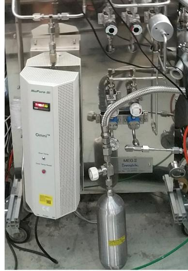
図 8.2 左：液体キセノン純化のためのモレキュラーシーブスによる純化ポンプ。
