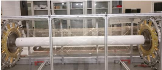
図 5.2 クリーンルームに置かれた組み立て途中のドリフトチェンバー。
