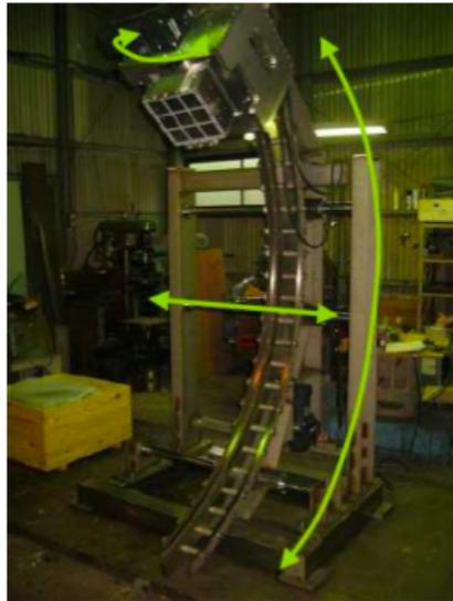
**Figura 2.24:** Schema della disposizione del calorimetro NaI (in basso la fotografia del suo supporto con l'indicazione dei possibili movimenti del rivelatore) e del bersaglio di idrogeno all'interno del rivelatore; l'asse  $z$  corrispondente alla direzione del fascio è entrante nel foglio.
