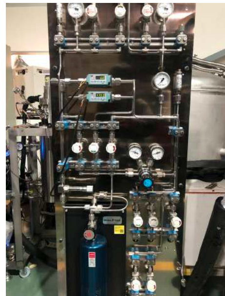
図 5.13: 液体キセノンの操作パネル。下部に見える青い円筒状のものがゲッターである。
