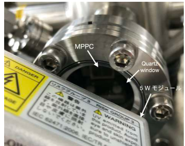
図 6.16: ランプ側からみたセットアップの写真。照射するときはこの周りをブラックシートで覆い、外部からの光を遮る。
