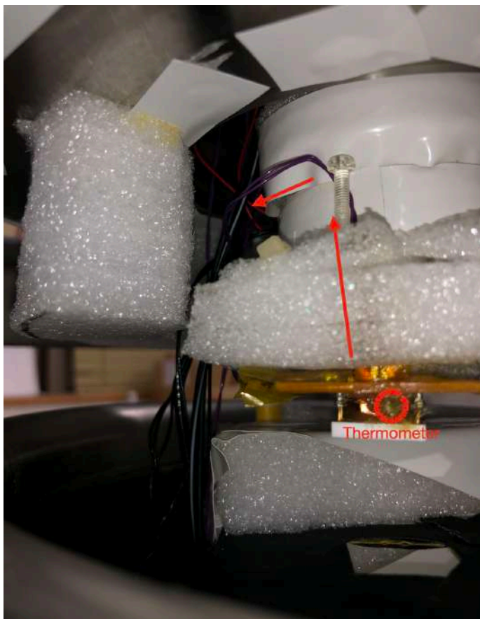
図 7.9: 温度計のケーブルは他のケーブルなどに接触している。
