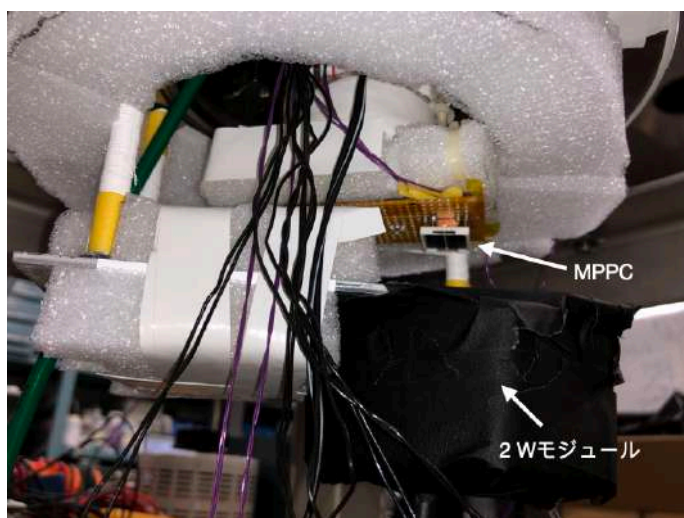
図 6.30: VUV 光を用いた表面損傷調査実験の照射時のセットアップ。
