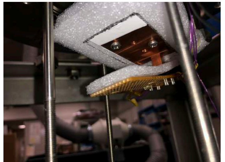
図 7.8: 低温部分の周りに発泡スチロールを巻いた。
