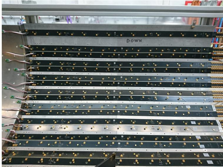
図 8.1 バックプレーンとサポートの全体像。左側のコブラの中央に入る部分はステップになっているため、温度センサーは PCB 上ではなく基板上に付いている。
