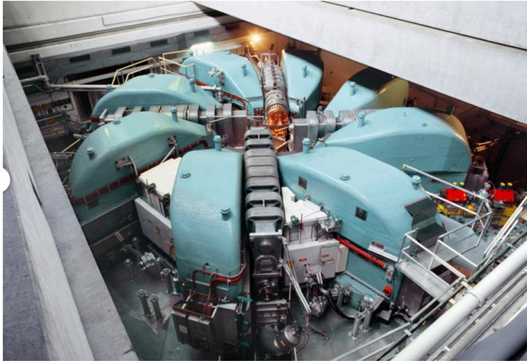
図 2.1 PSIにあるリングサイクロトロン。陽子を光速の80%程度まで加速する [8]。
