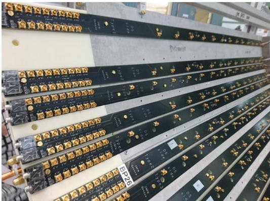
図 3.4 バックプレーンの信号読み出しコネクタ部の写真。ここから読み出された信号は同軸ケーブルによって WaveDREAM に送られる。
