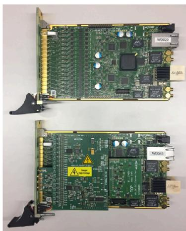
図 9.1 WaveDREAM ボードの写真 [6]。下のものは高電圧印可用のボード付き。
