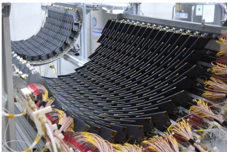
図 3.1 陽電子タイミングカウンターの写真。2017 年秋に 512 個全てのピクセル（細分化されたシンチレータタイル）製作およびアセンブリが完了した。
