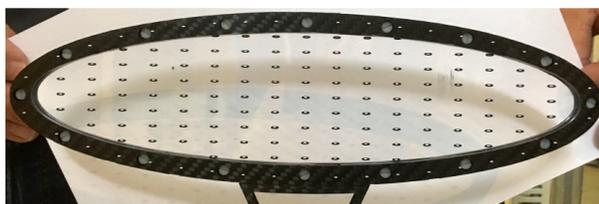
図 2.23 MEG II 実験でのシンチレータターゲット [6]。
